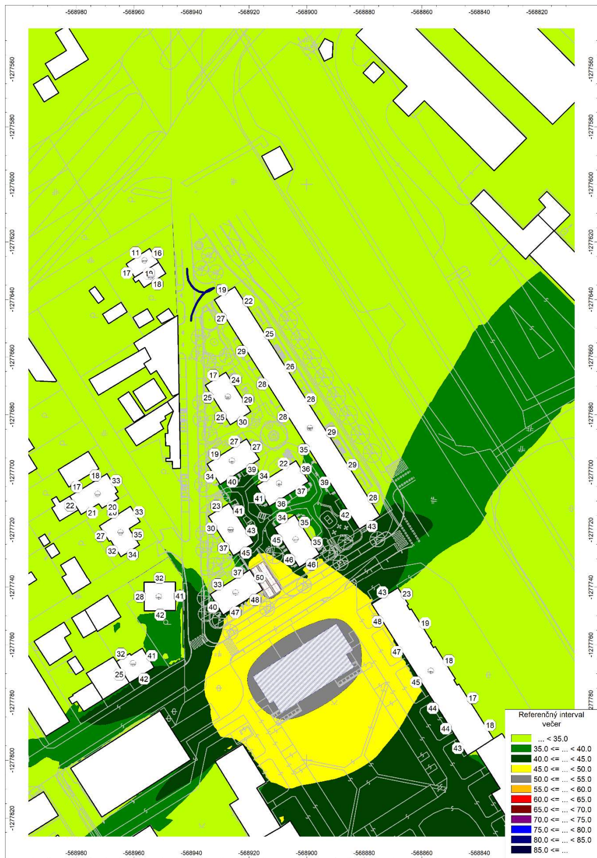
Príloha 9.8: Vplyv hluku z iných zdrojov v budúcom stave (statická doprava, zásobovanie) – L_{aeq} [dB] pre ref. interval večer - farebná škála pre výšku 1,5m nad terénom
