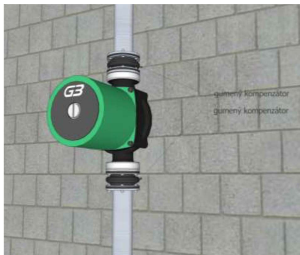
Obr. 7.3 Použitie gumených kompenzátorov pre pripojenie obehového čerpadla
