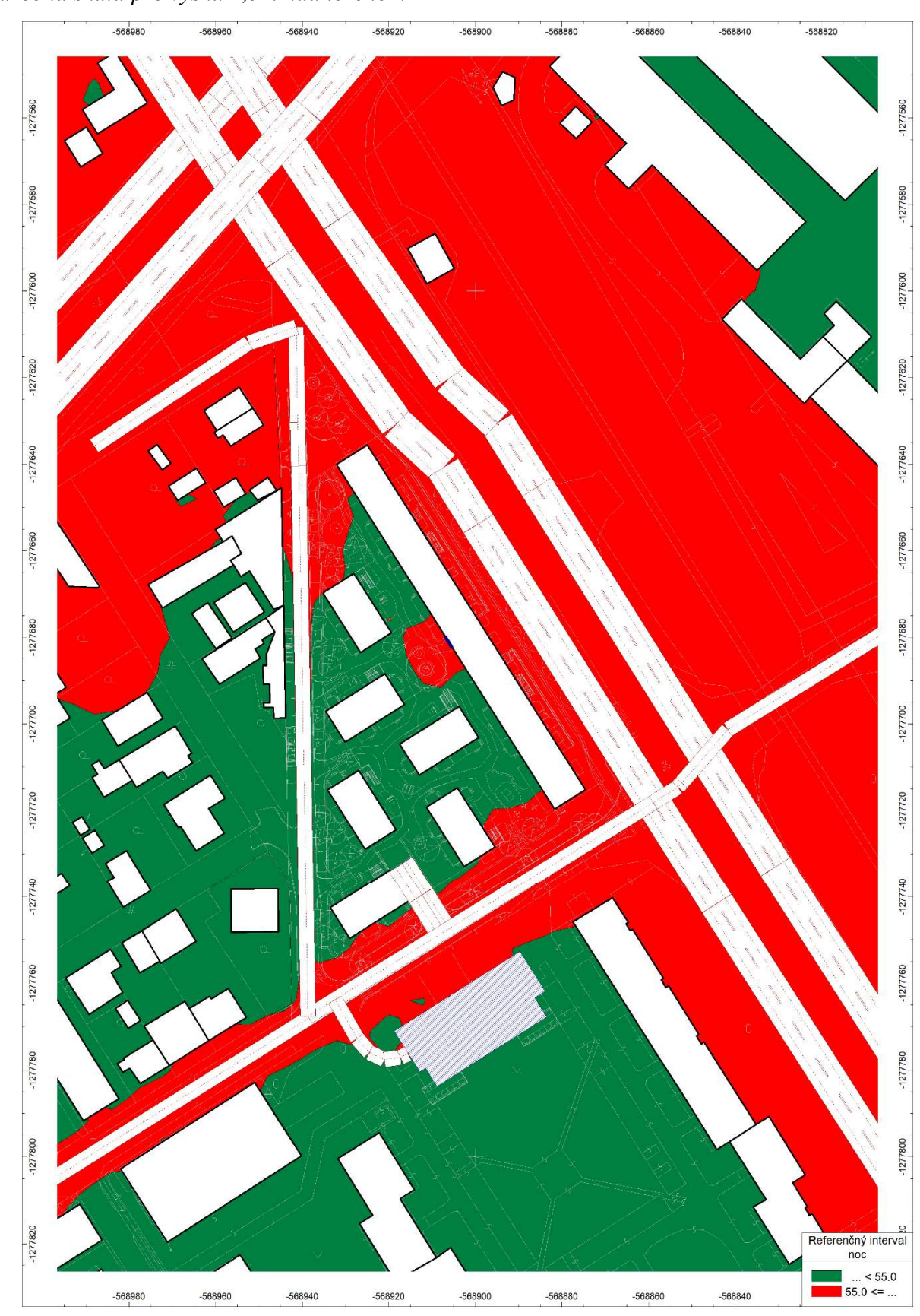
Príloha 9.6: Tichá zóna v zmysle bodu 1.9 Vyhlášky 549/2007 Z.z – L_{aeq} [dB] pre ref. interval noc - farebná škála pre výšku 1,5m nad terénom
